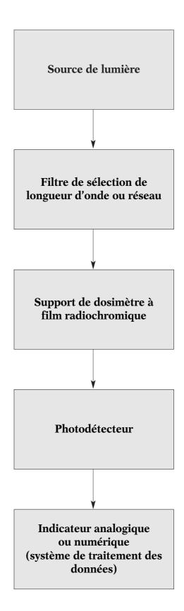
Fig. 1 Diagramme de l'instrument indicateur utilisé dans un système de dosimétrie par film radiochromique
