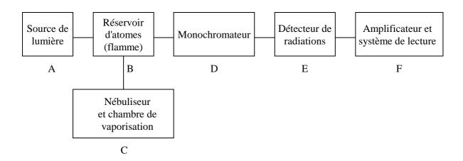
Figure 1 - Schéma d'un spectromètre d'absorption atomique à flamme
