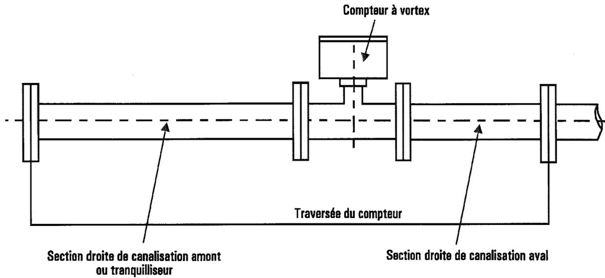
Figure 2 Installation type de compteur à vortex
