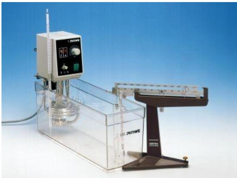
*Figura 13: Balanza de Mohr*
