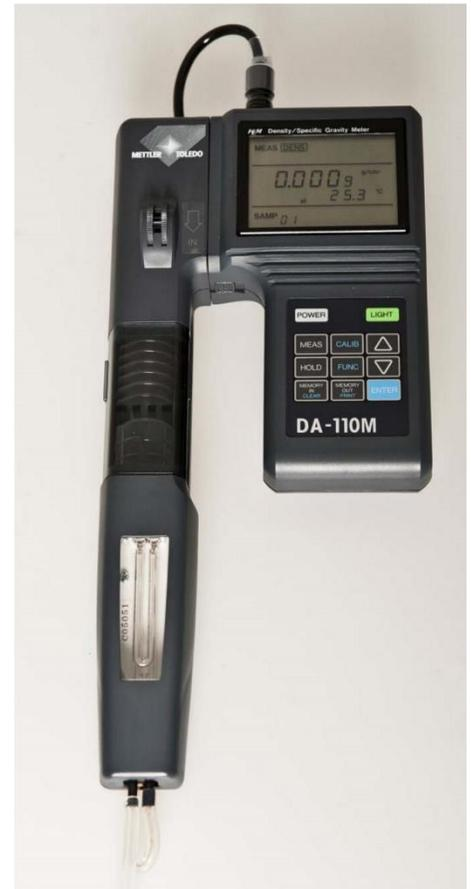
Figura 12: Medidor de densidad electrónico portátil
