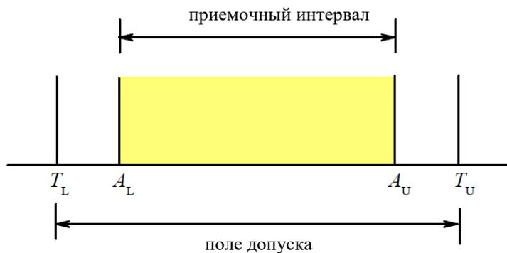
**Рисунок 12** – Двойная оценка соответствия, когда решения основываются на измеренных значениях величины. Задано, что истинное значение измеряемого свойства (измеряемой величины) объекта находится в поле допуска, заданного границами ( $T_L$ ,  $T_U$ ). Объект принимается как соответствующий, если измеренное значение свойства находится в приемочном интервале, заданным границами ( $A_L$ ,  $A_U$ ), а в противном случае бракуется как несоответствующий.
