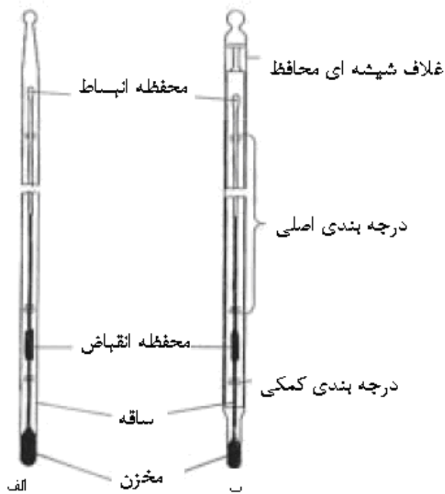
شکل ۱ اجزای اصلی یک دماسنج مایع در شیشه الف دماسنج بدون غلاف ب دماسنج غلافدار
