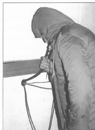
Fig. 1 Essai in vivo: un Sujet placé dans une enceinte climatique à 0 °C souffle dans l'embout d'un éthylomètre maintenu à 20 °C à l'extérieur de l'enceinte.
