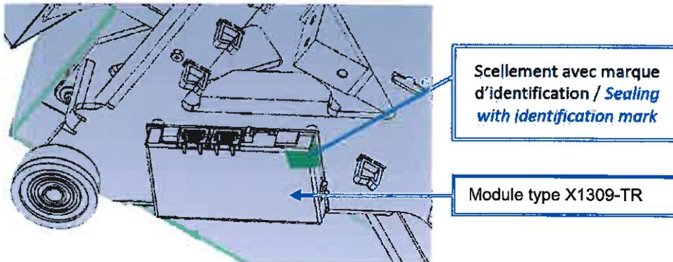
L'instrument est également doté d'un scellement logiciel. Ce scellement consiste en une sécurisation logicielle qui permet de lier les données métrologiques et d'identification de l'instrument détenues par le dispositif de traitement de données analogiques avec celles détenues par le terminal principal.
